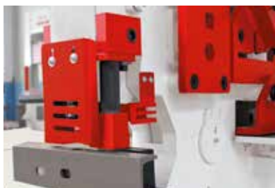
Vysmekovací stanice s ochranným zařízením
