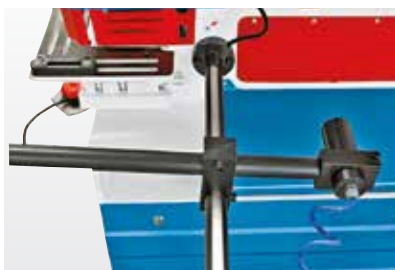
Zadní doraz s automatickým spouštěním řezu
